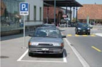
Ces places de parc parallèles à la chaussée permettent d'éviter les manœuvres dangereuses. La distance de 50 cm entre la place et le bord de la chaussée limite les risques de conflit avec les cyclistes lors de l'ouverture des portes (Köniz, BE).
